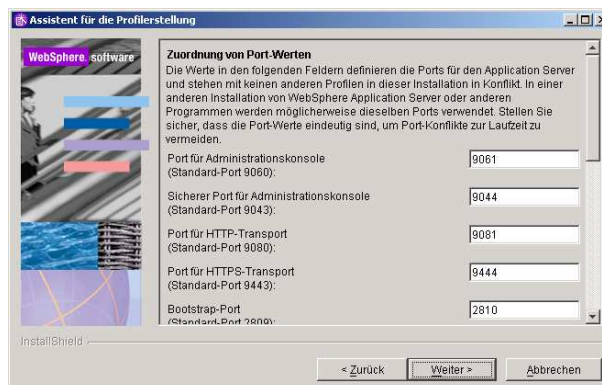
Abbildung 39: Zuordnung von TCP/IP-Ports
